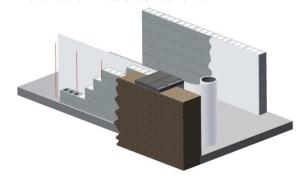
Achtung: Der vorgestanzte Skimmerausschnitt befindet sich üblicherweise ca. 200 cm vom äußeren Wandende entfernt. Achten Sie darauf, daß beim Einsetzen der Stahlwand sich der Skimmerausschnitt auch am gewünschten, richtigen Ort befindet. Bei Schwimmbecken mit 2 Stahlwänden befindet sich der Skimmerausschnitt in der Wand 1.
