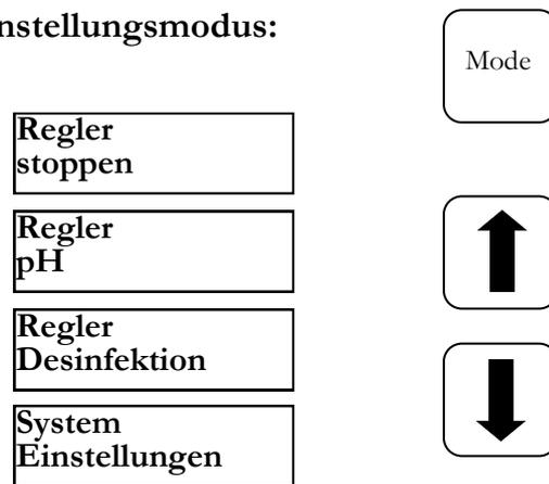
Durch einmaliges Drücken der Mode Taste gelangen Sie in den Einstellungsmodus. Drücken Sie jetzt nochmals die Mode Taste und Sie befinden sich wieder im Betriebsmodus. Mit den Pfeiltasten können Sie die gewünschte Option auswählen.
