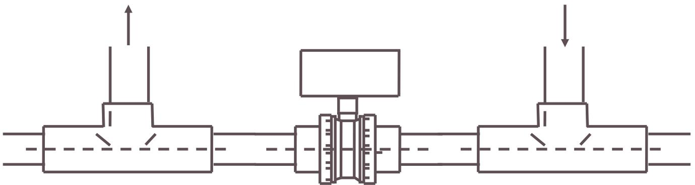
Achtung: Bei der Inbetriebnahme die Leichtgängigkeit des Kugelhahns prüfen! Schäden wie gebrochene Kupplung, Motor- oder Getriebeschaden unterliegen nicht der Garantie und sind bei schwergängigen Kugelventilen vorprogrammiert.
