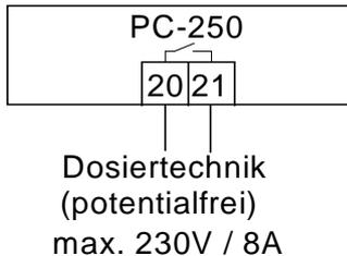
Zwischen den Klemmen 20 und 21 liegt im Steuergerät ein potentialfreier Relaiskontakt. Dieser kann beispielsweise zur Ansteuerung der Dosiertechnik verwendet werden (der Kontakt ist während des Filterbetriebes geschlossen).
