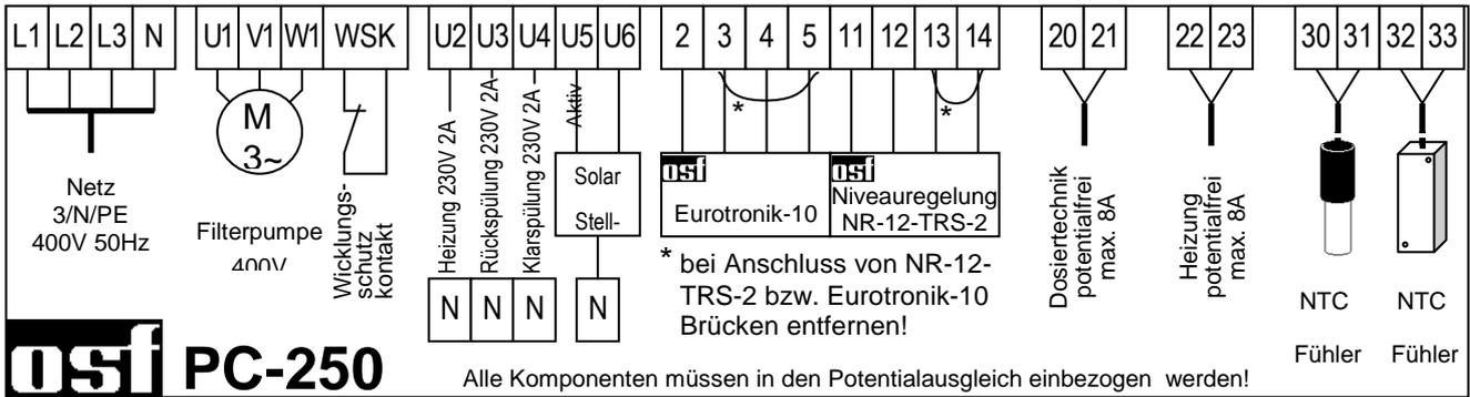
Diese Steuerung ist für den Anschluss einer Filterpumpe mit Drehzahlregelung nicht geeignet. Für derartige Pumpen führen wir andere Steuerungen im Lieferprogramm.
