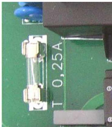
Die elektronische Steuerung ist durch eine 0,25A Feinsicherung auf der Leiterplatte im Inneren des Gerätes abgesichert. Der Kurzschluss-Schutz für die Filterpumpe ist durch bauseitige Vorsicherungen von max. 16A sicherzustellen.
