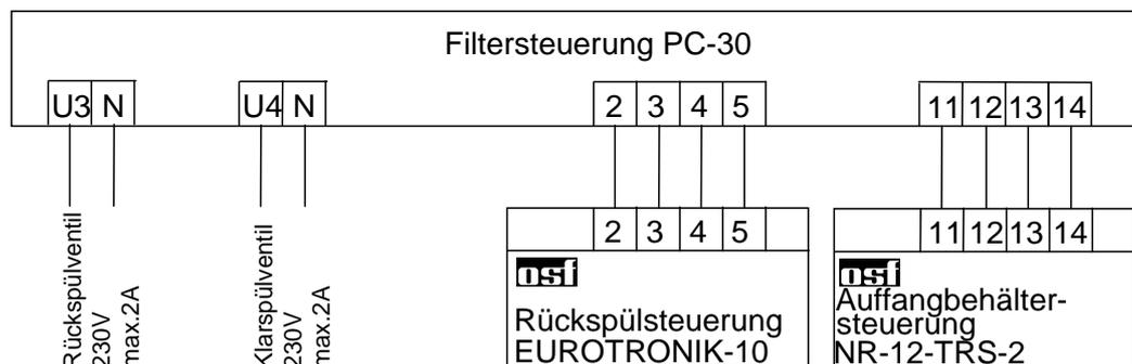
An die Klemmen U3 und N kann ein 230V Stangenventil für Rückspülen angeschlossen werden.
