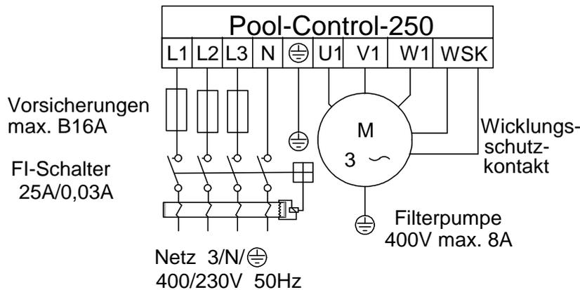
Die werksseitig eingefügte Brücke zwischen den beiden mit WSK bezeichneten Klemmen muss bei Anschluss einer Pumpe mit Wicklungsschutzkontakt entfernt werden. Erfolgt kein Anschluss, dann muss sie eingeschraubt bleiben. Die Klemmen führen Netzspannung!
